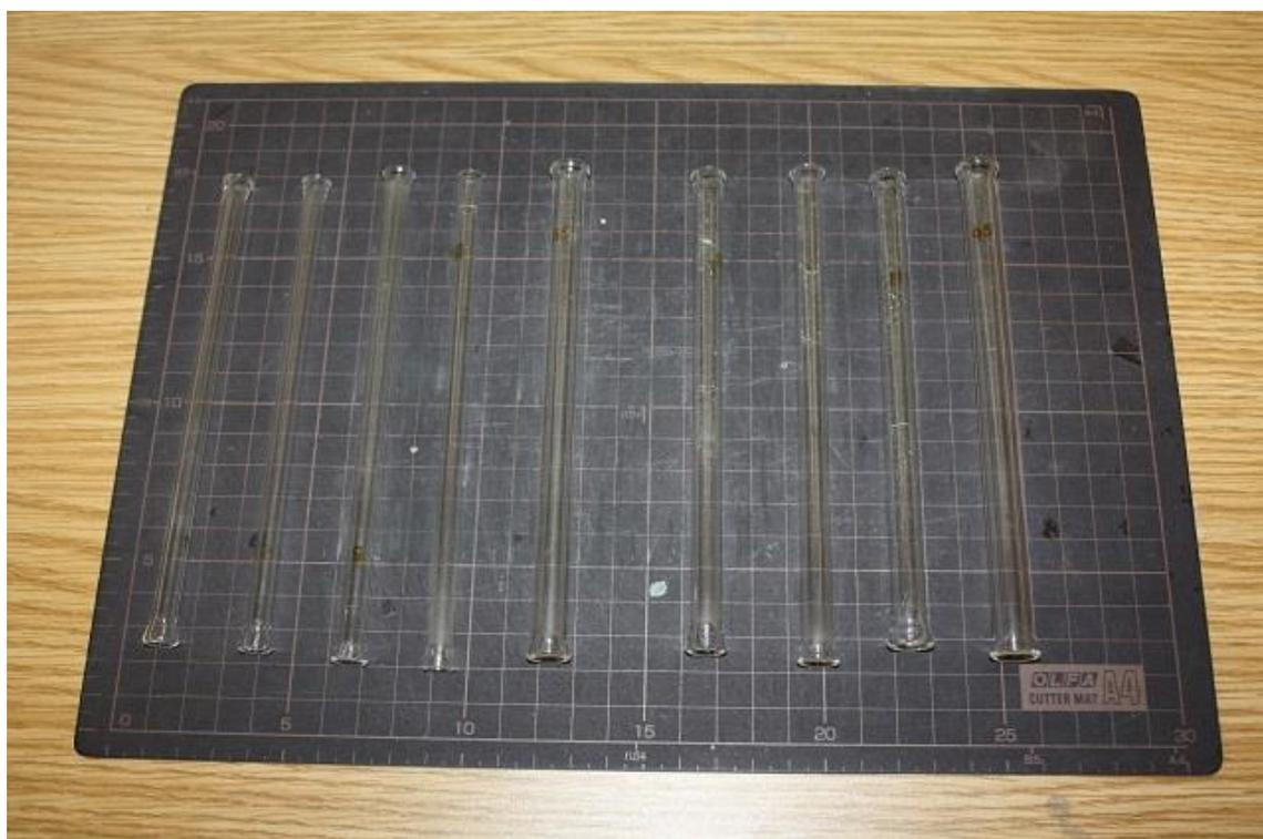
画像2： カヤや羽根の径を修正するためのガラス管、4mm～6.5mm まで、0.5mm 刻み
