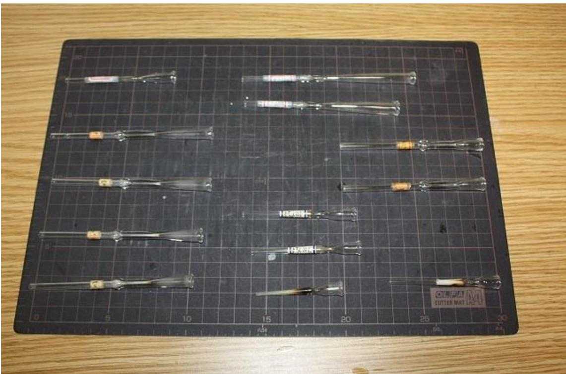
画像 5： ウキの上部、下部を絞るためのガラス管、直径とテーパーの長さで種類が異なり、
