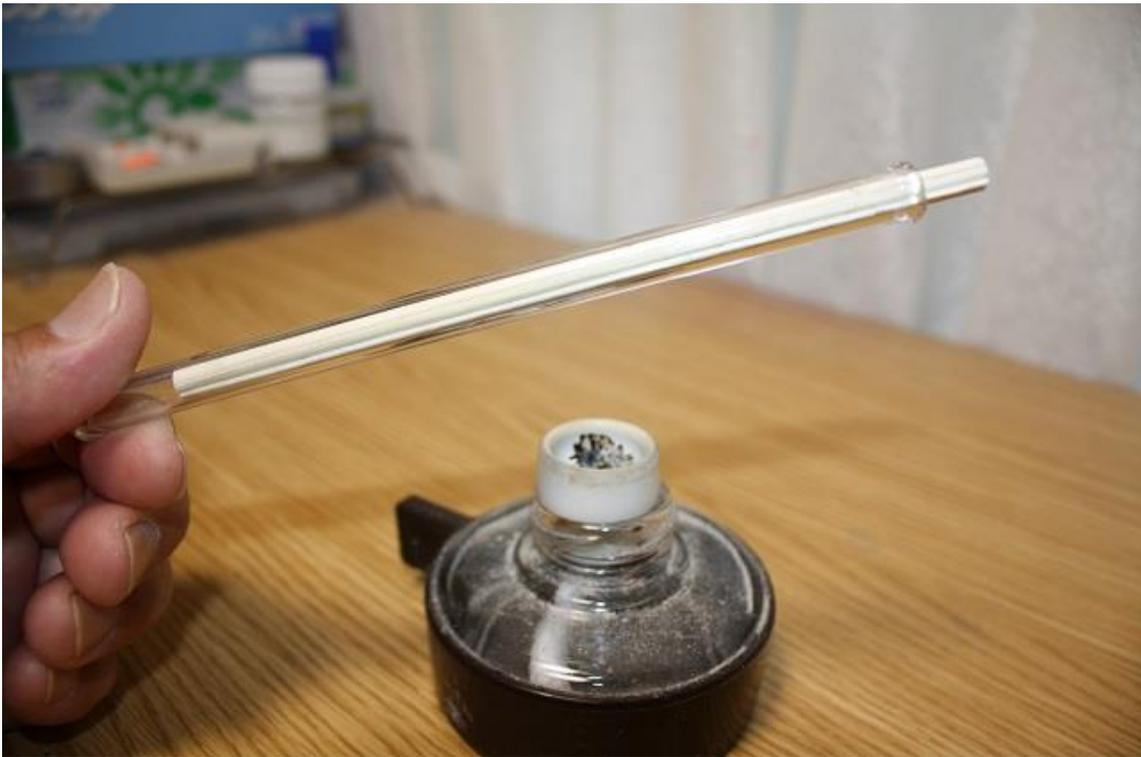
画像4：羽根をガラス管に入れて加熱している様子
